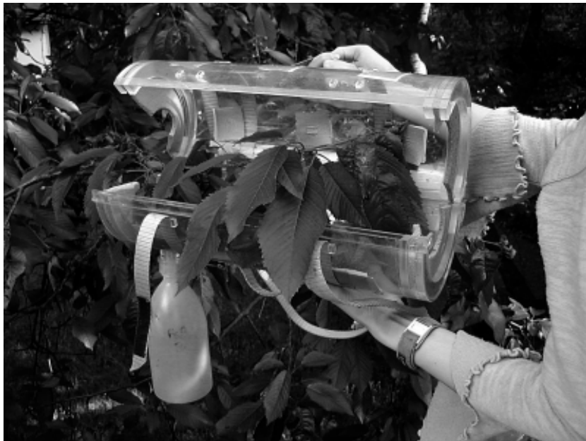
Abb. 2 Sammelrohr, zur Beprobung eines Zweiges aufgeklappt
